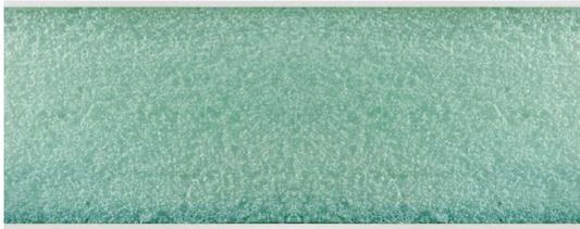
La cabina è realizzata con pannelli sandwich da 42 mm. Questi pannelli sono composti da 40 mm di PET, il lato esterno da 1 mm di bilanciante e il lato interno da 1 mm di HPL.
