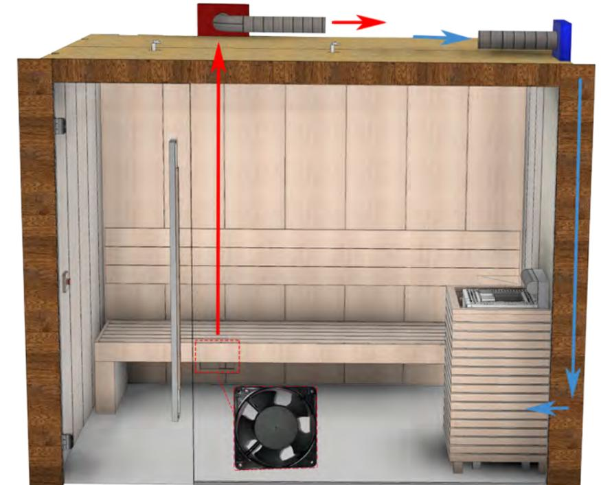
La ventilazione forzata è garantita da valvole meccaniche collegate alle valvole UTA dell'edificio.
